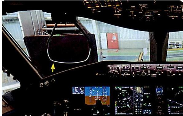
B787のcockpit。両側の席ともにヘッドアップ・ディスプレイ(写真中の矢印)がつけられたのは、B787がはじめてだ。中央の五つのディスプレイはそれぞれ切りかえることができ、一部が故障して使えなくなってもほかで代用が可能だ。操縦桿(コントロールホイール、座席正面)を前後に押し引きすることで機首の上下(水平尾翼のエレベーターを動かす)を、左右にまわすことで機体の傾き(旋回するときの動き、主翼のエルロンなどを動かす)を制御する。足下のペダルでは、機首の左右(垂直尾翼のラダーを動かす)を制御する。写真は2011年9月28日に羽田空港に到着した初号機を撮影。
